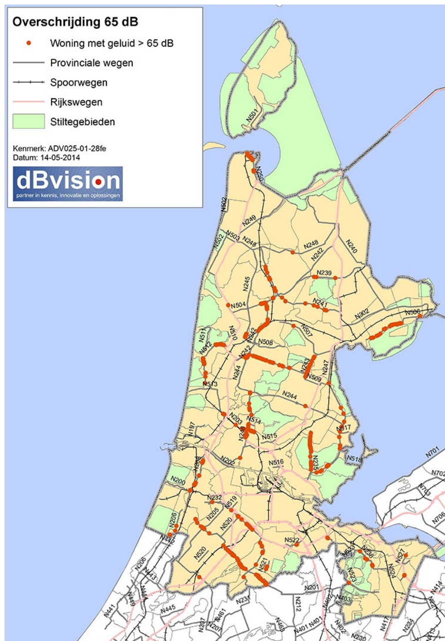
Figuur 6. Locaties overschrijding plandrempeL 65dB langs provinciale wegen
