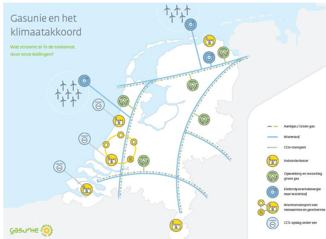
Figuur 8 - Schematische weergave van de landelijke waterstofbackbone waarvan Gasunie als trekker optreedt
