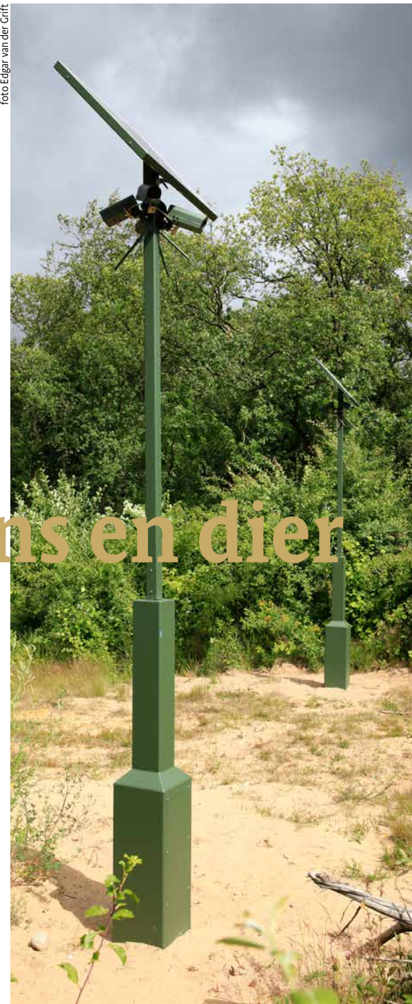
Figuur 3. De cameravallen – van het type Reconyx MicroFire MR5 – op Natuurbrug Laarderhoogt. De camera's zijn schuin naar beneden gericht in een hoek van circa 60 graden. Deze infraroodcamera's hebben een bewegings- en warmtesensor, een reactietijd van 0,1 sec, een maximaal detectiebereik van 12 meter en een flitsbereik (infrarood) van 15 meter.
