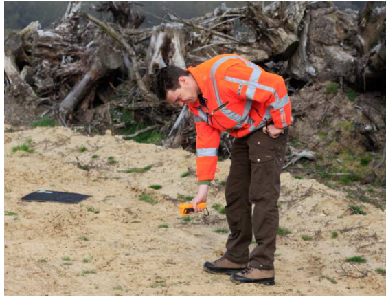
Temperatuurmeting onder de tapijttegels
