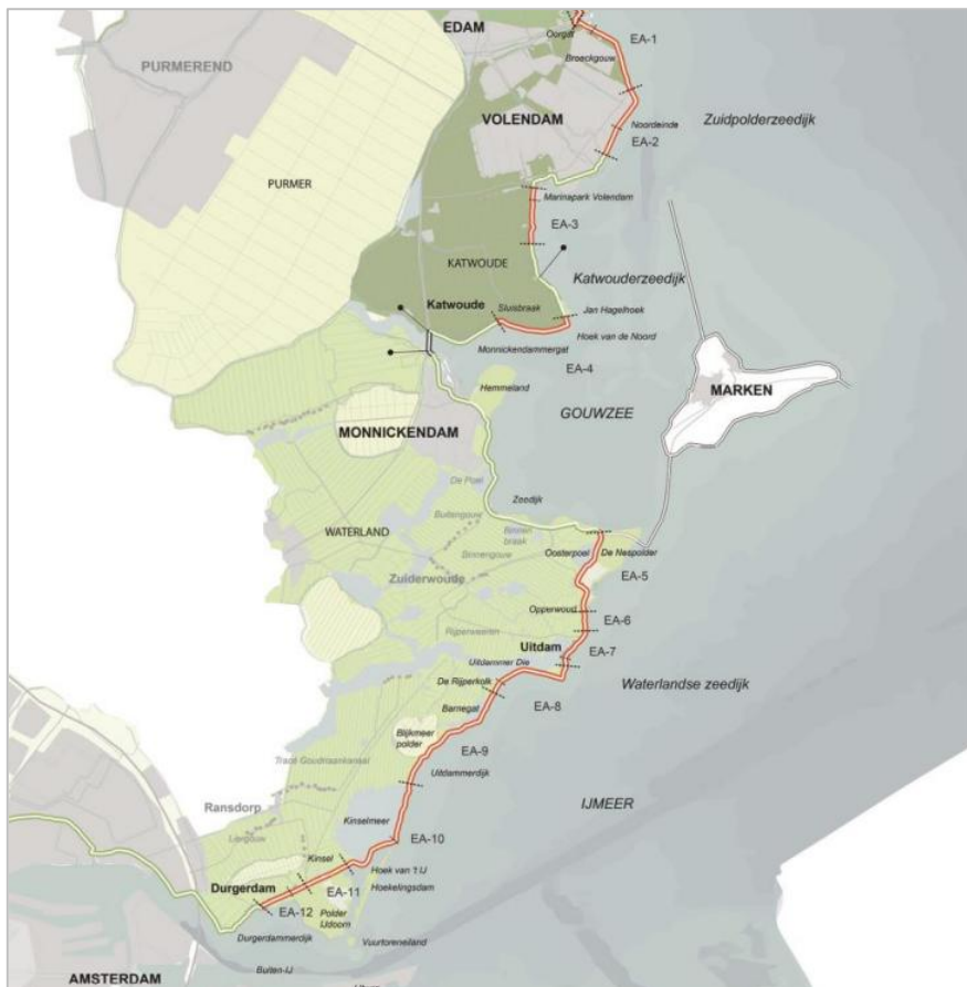
Figuur 1.2: De te versterken dijktrajecten (met sectienummering) tussen Edam en Amsterdam. Bron: HHNK 2015.
