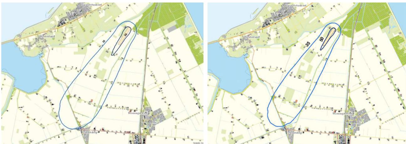
figuur 2 contouren van L_{Aeq,24h} = 35 dB(A) en 50 dB(A) (li. 12 starts met Piper, re. 30 starts met Dimona)
