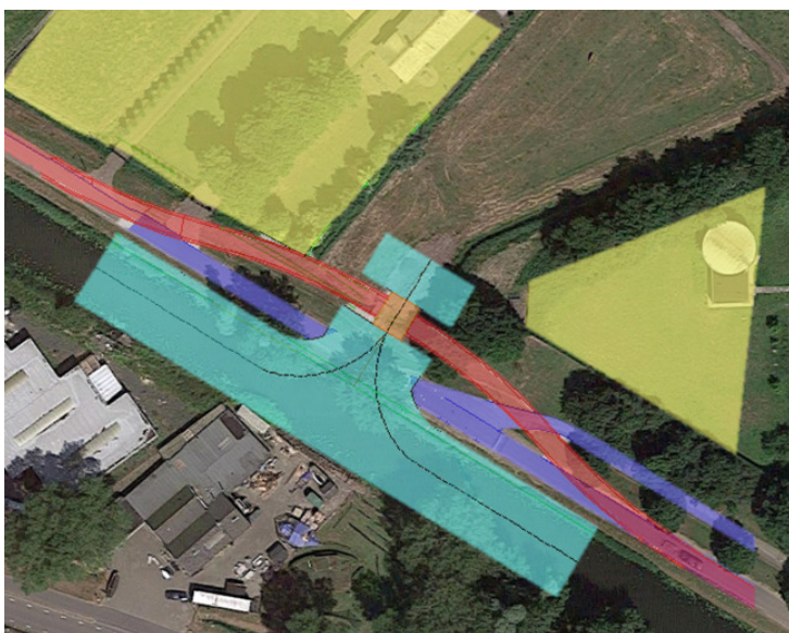
Figuur 13: Een indicatie van een mogelijke oplossing voor de aansluiting van de vaarweg en de verlegging (rood) van de Amsterdamsestraatweg (blauw)
