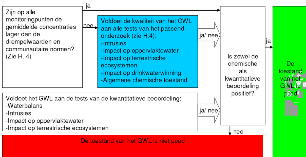
Afbeelding 2. Stroomschema beoordeling toestand grondwater (Bron: Voorlopig protocol voor de toestandbeoordeling van grondwaterlichamen, versie 2, 26 maart 2009, RIVM en Deltares)
