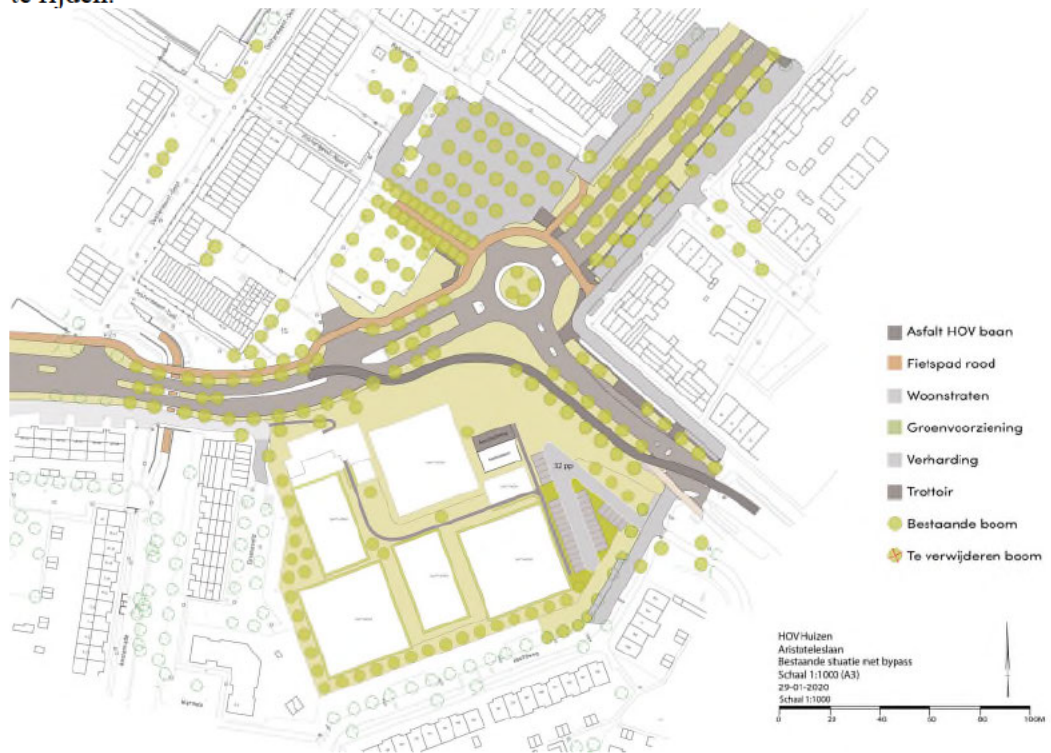
Figuur 15: Bestaande rotonde met Bypass voor bus
