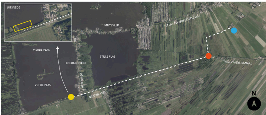
Figuur 1: overzicht van de overslaglocatie (geel), de leidingen (witte onderbroken lijn), de booster (oranje) en het depot (blauw).
