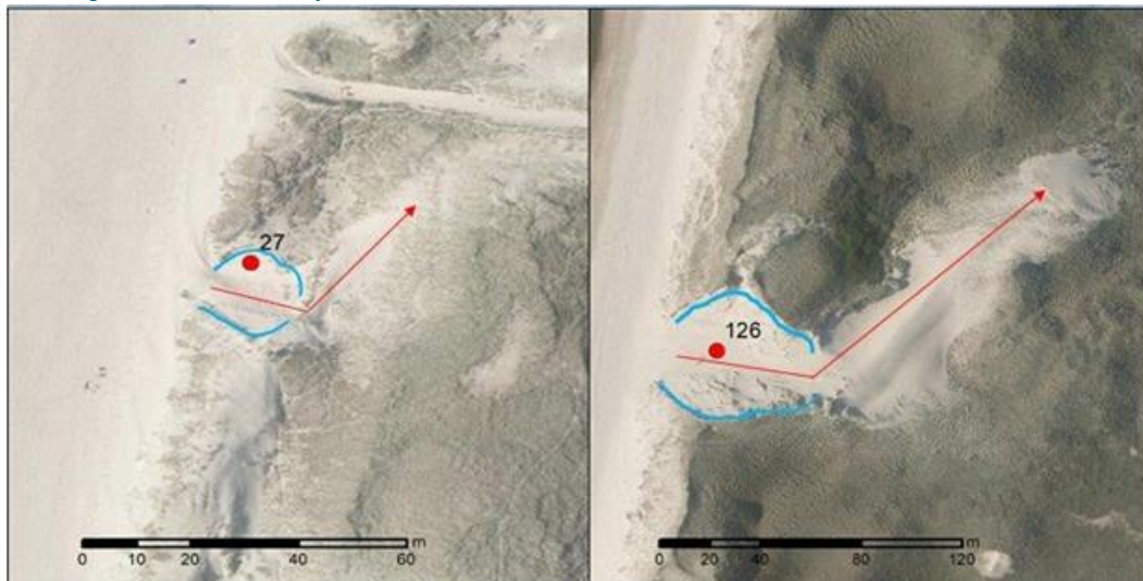
Afbeelding 3.2 Verschil in ruimtelijk effect tussen stuifkuilen (links) en kerven (rechts)
