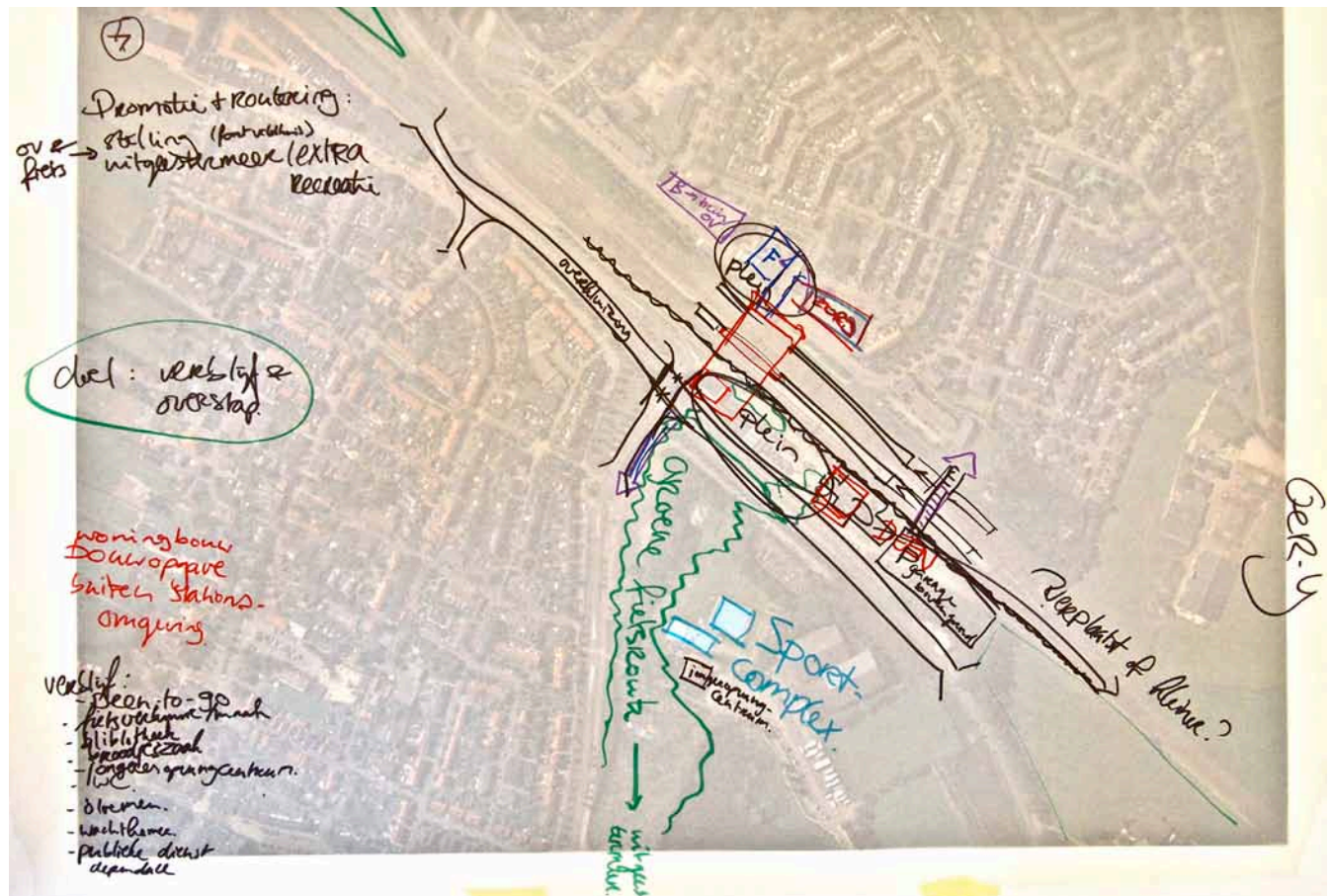
Een opvallende overkapping, een uitgebreide tunnel én een voetgangersbrug verminderen de barrièrewerking van de tussenliggende infrastructuur
