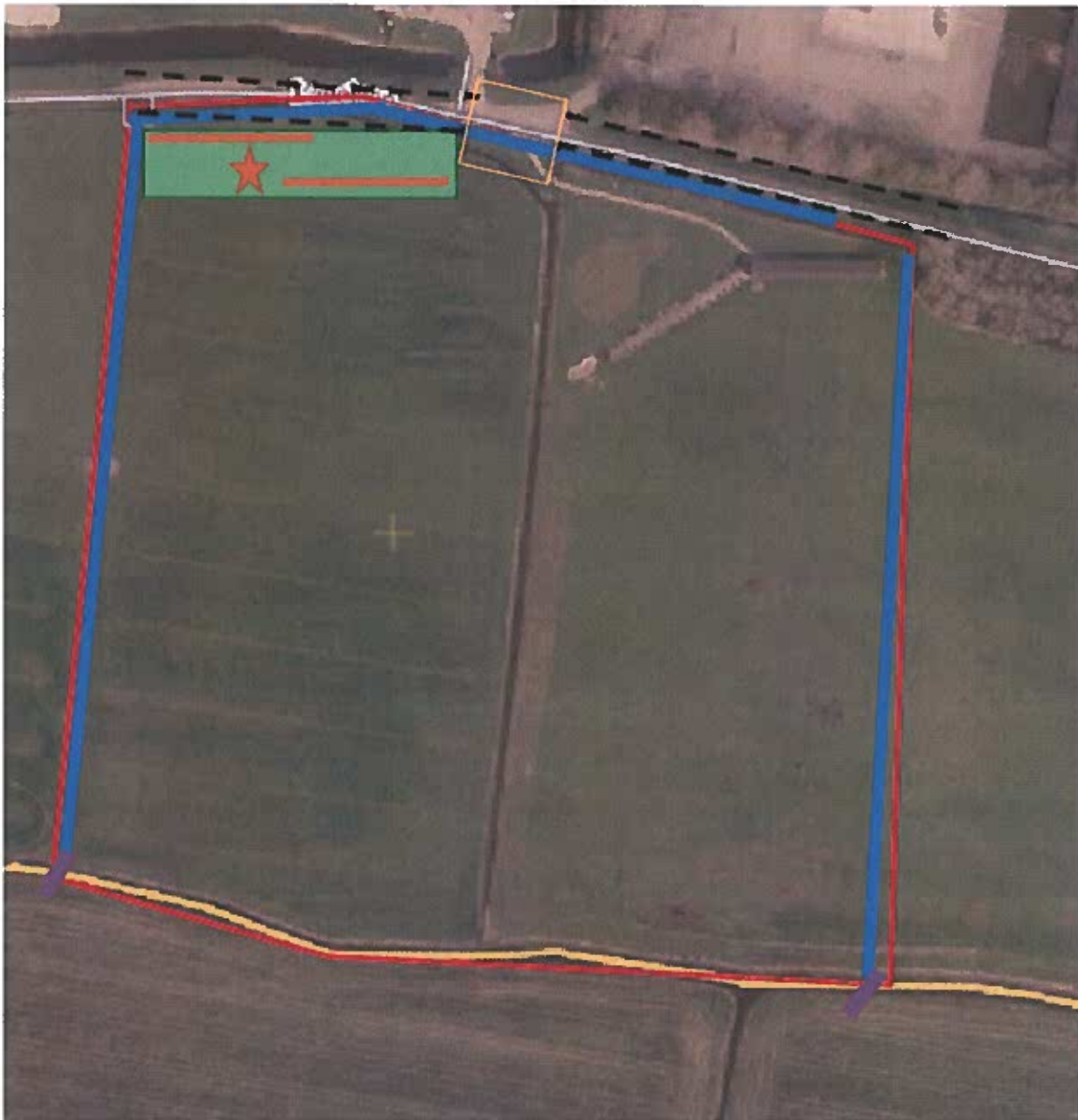
Figuur 18. Overzicht maatregelen in deelgebied 4, de nieuwe driving range. De oevers kunnen aan de 'binnenzijde' natuurvriendelijk worden ingericht. Bij het Limmerdijkje kan op een tweetal plaatsen een loopplank (paars aangegeven, 30 cm breed) worden geïnstalleerd om een noord-zuid verbinding verder te realiseren. In de noordwesthoek kan een zone met houtwallen en kruidenrijk grasland worden ingezaaid met indien mogelijk een marterhoop of marterkast. Het gele vierkant geeft indicatief de locatie van de aan te leggen golftunnel. De locatie exacte is nog niet definitief maar rasters dienen aan beide zijden aan te sluiten op de golftunnel zodat deze 's nachts door marters gebruikt kan worden als noord-zuidverbinding. (De maatregelen zijn vooralsnog indicatief weergegeven en dienen nog nader te worden bepaald en gelokaliseerd in overleg met de eigenaar en beheerder van het gebied.
