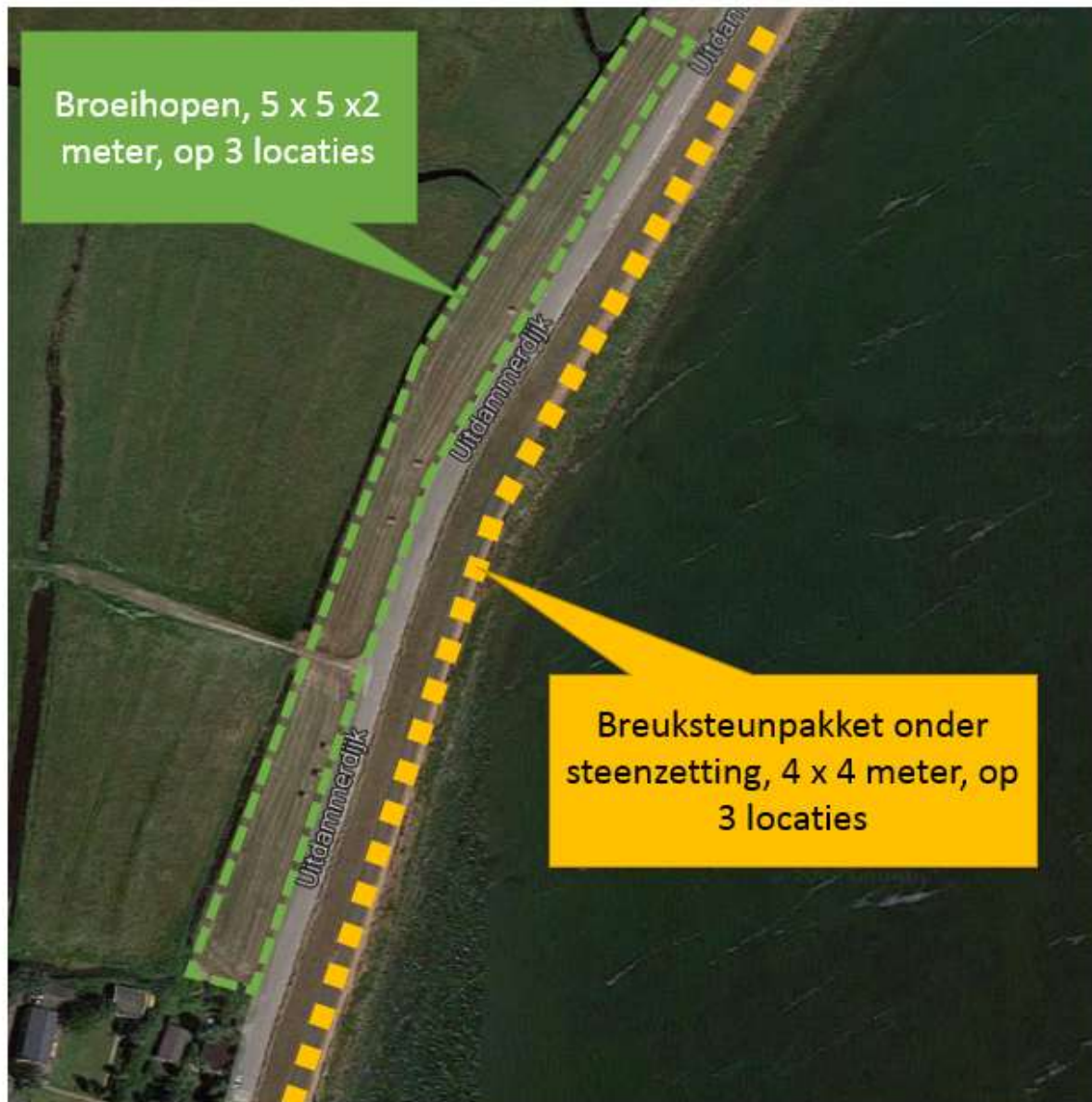
Afbeelding 37: Compensatiemaatregelen op de locatie "Nieuwe plek" (zie voor locatie Afbeelding 29). Aan de buitenzijde moeten op drie locaties breuksteunpakketten onder de steenzetting worden gerealiseerd. Aan de binnenzijde moeten broeihopen worden gerealiseerd op drie locaties. Hiervoor is in principe voldoende ruimte op de binnenberm met een groene onderbroken lijn.
