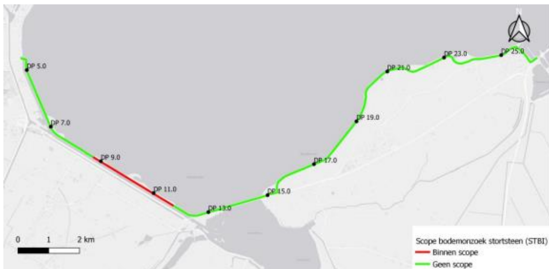
Afbeelding 6 Scope maatregel stortsteen/micr stabiliteit. Bron: Witteveen+Bos.
