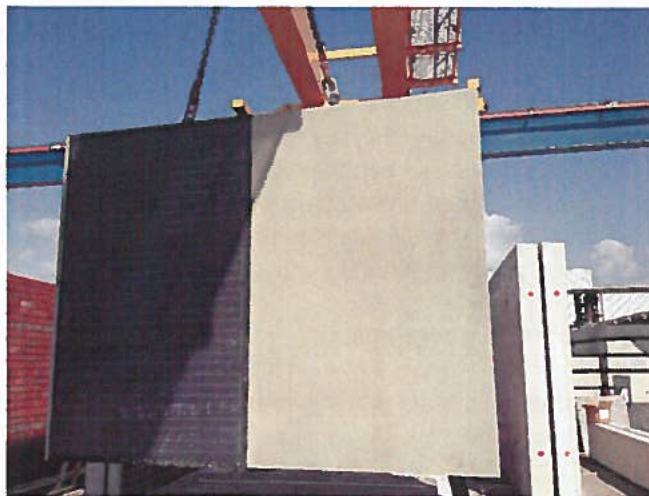
Figuur 7 SolaRoad element in de kraan, kort na productie.
