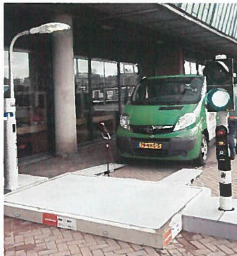
Figuur 2 2011: Eerste demonstrator SolaRoad
