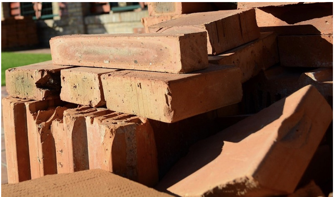
Bakstenen kunnen goed worden geoogst voor hergebruik.
