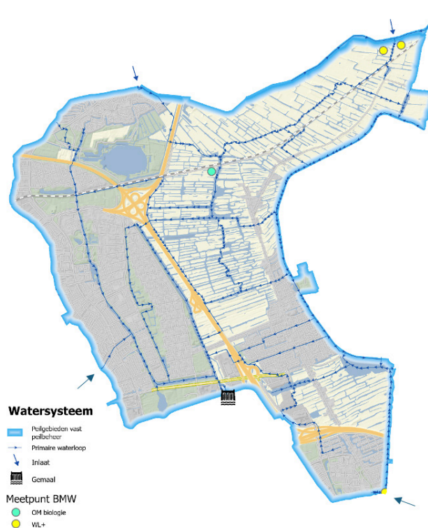
Figuur20: Watersysteem van Oostzanerveld binnen peilgebied 5330. bronnen: peilgebied en waterloop afkomstig uit Legger HHNK (2021), inlaat en gemaal herleid uit bestemmingsplan (2013, NL.IMRO.0431. BP2012003001-0301). Meetpunten aangeleverd op kaart door HHNK en op het oog overgenomen.
