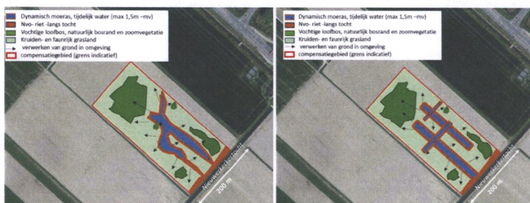
Figuur 4-8 Schetsontwerpen stapsteen natuurverbinding maaiveldvolgend (boven) of met rechte natte vlakken en lijnen (rechts)
