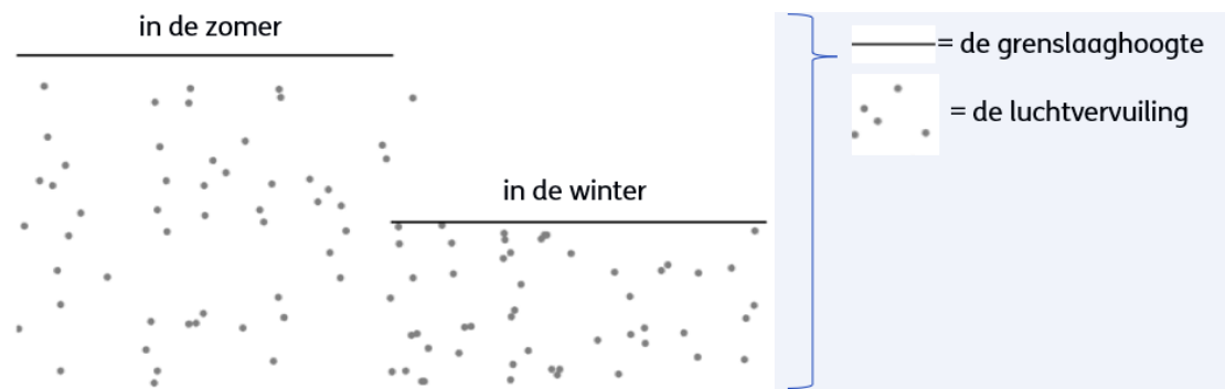
Figuur 2.2: Illustratie van de grenslaaghoogte met links een hoge grenslaag (typisch in de zomer) en rechts een lage grenslaag (typisch in de winter). Het aantal bolletjes illustreert de luchtvervuiling en is voor links en rechts gelijk. Rechts is er sprake van een hogere concentratie, doordat er minder ruimte is voor menging van de lucht.
