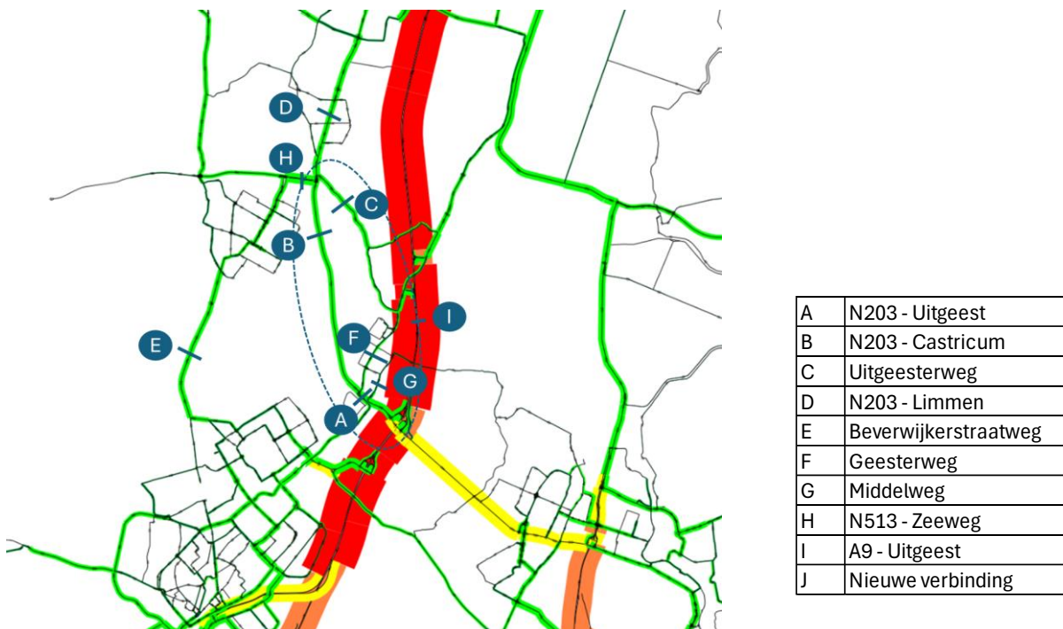
Figuur 21: meetpunten verkeersprognoses (de kleur en lijndikte is een indicatie voor hoogte van de intensiteit)
