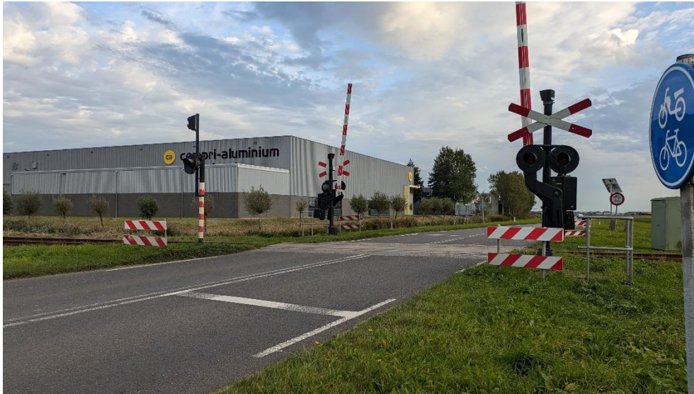
Zicht dat een fietser heeft bij nadering vanaf de westkant van de oversteek. De spoorbomen ontnemen een groot deel van het zicht op verkeer vlak voor de spoorweg.
