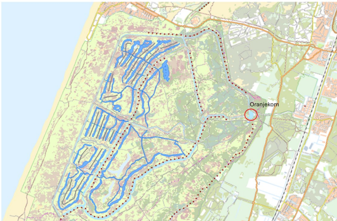
Afbeelding 2.5 Overzicht van het oppervlaktewater infiltratie- en winsysteem dat bestaat uit: verdeeljijvers, toevoersloten, infiltratiegeulen (blauw), win- en voorraadkanalen (licht blauw), drains (lijnen grijs) en diepe winputten ( punten donkerrood). De Oranjekom is met rood omcirkeld
