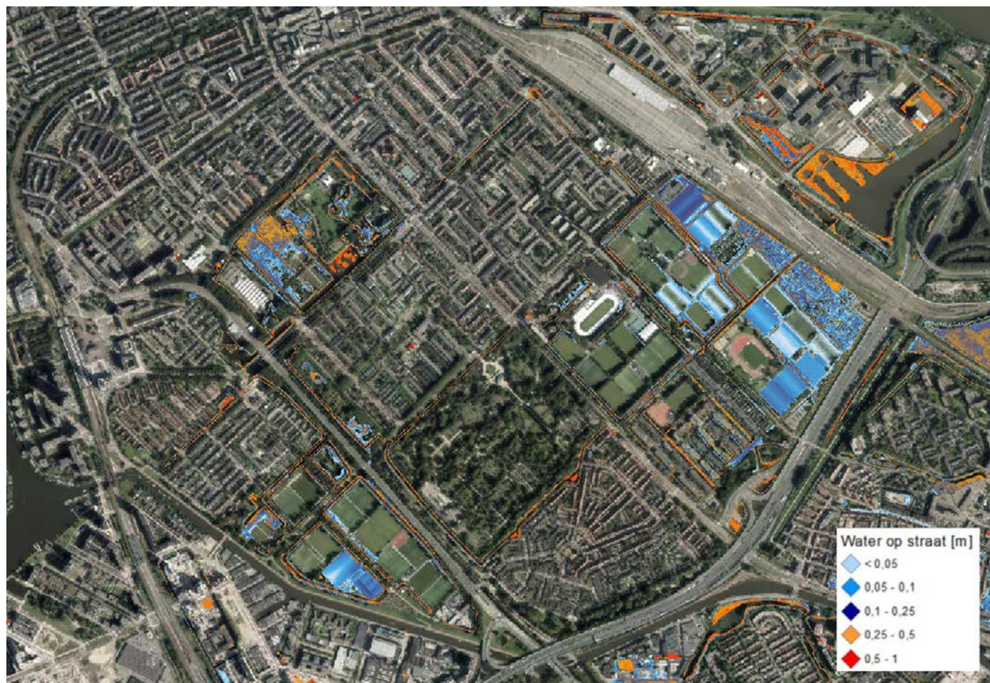
Figuur C-3. Maximale waterdiepte [m] in Watergraafsmere bij een berekening van 200 mm in 48 uur (met Sobek model)
