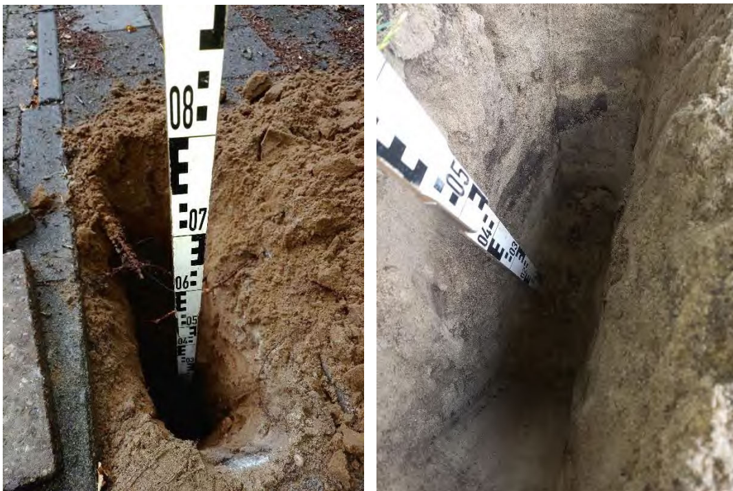
Foto 10 links: Weergave proefsleuf in het trottoir op locatie E laat een bijna exact gelijk beeld zien vergeleken met locatie G op foto 11 (rechts). Dit duidt op een homogeen bodembeeld binnen locaties in- of nabij verharding in het projectgebied.
