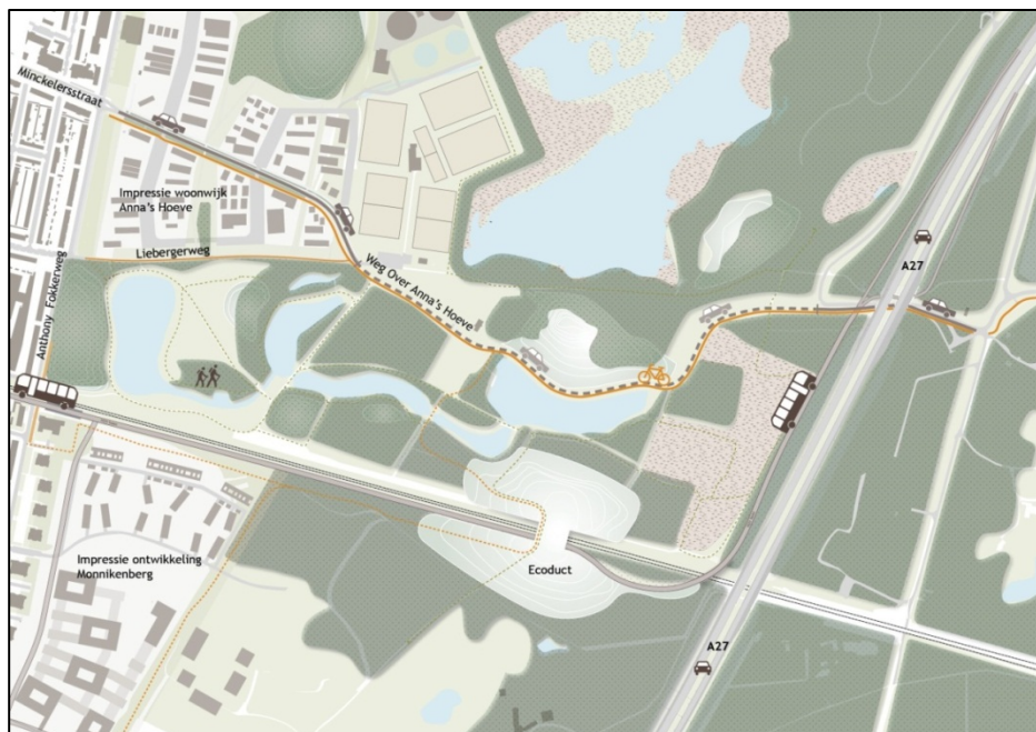
Figuur 3 Schetsmatige weergave van ontwerpvariant 1B. De HOV kruist de spoorlijn via een flyover oostelijk van Natuurbrug Anna's Hoeve. De WoAH wordt niet verplaatst. Mitigatie van de WoAH gebeurt door het afsluiten van de weg voor verkeer tijdens de avond/nacht (bron: Movares/Posad).
