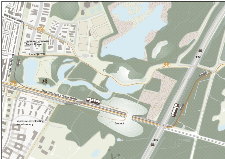
Figuur 5 Schetsmatige weergave van ontwerpvariant 2A. De HOV kruist de spoorlijn via een fly-over westelijk van Natuurbrug Anna's Hoeve. De WoAH is gebundeld met de spoorlijn (bron: Movares/Posad).
