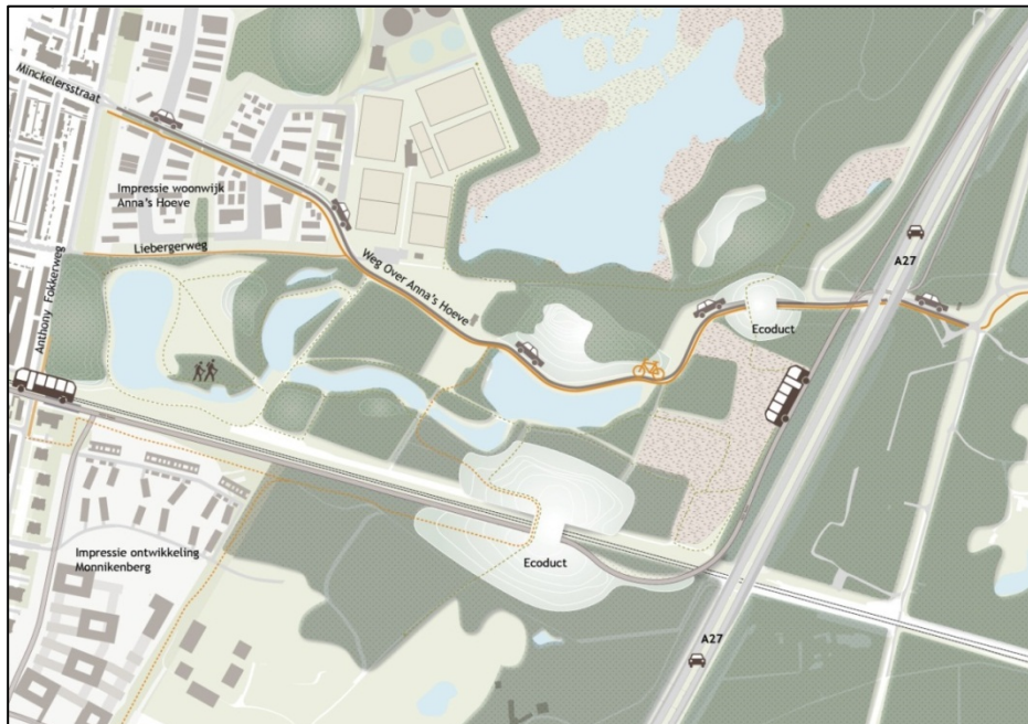
Figuur 4 Schetsmatige weergave van ontwerpvariant 1C. De HOV kruist de spoorlijn via een fly-over oostelijk van Natuurbrug Anna's Hoeve. De WoAH wordt niet verplaatst. Mitigatie van de WoAH gebeurt door de aanleg van een ecoduct (bron: Movares/Posad).
