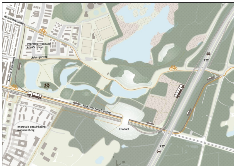
Figuur 1 Schetsmatige weergave van ontwerpvariant 1A. De HOV kruist de spoorlijn via een fly-over oostelijk van Natuurbrug Anna's Hoeve. De WoAH is gebundeld met de spoorlijn (bron: Movares/Posad).
