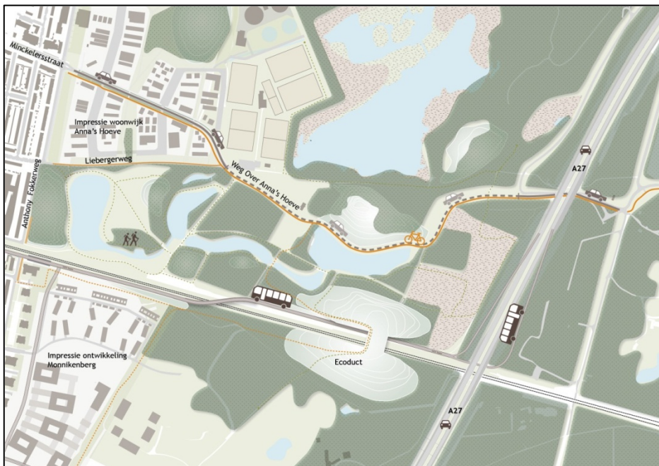
Figuur 6 Schetsmatige weergave van ontwerpvariant 2B. De HOV kruist de spoorlijn via een fly-over westelijk van Natuurbrug Anna's Hoeve. De WoAH wordt niet verplaatst. Mitigatie van de WoAH gebeurt door het afsluiten van de weg voor verkeer tijdens de avond/nacht (bron: Movares/Posad).
