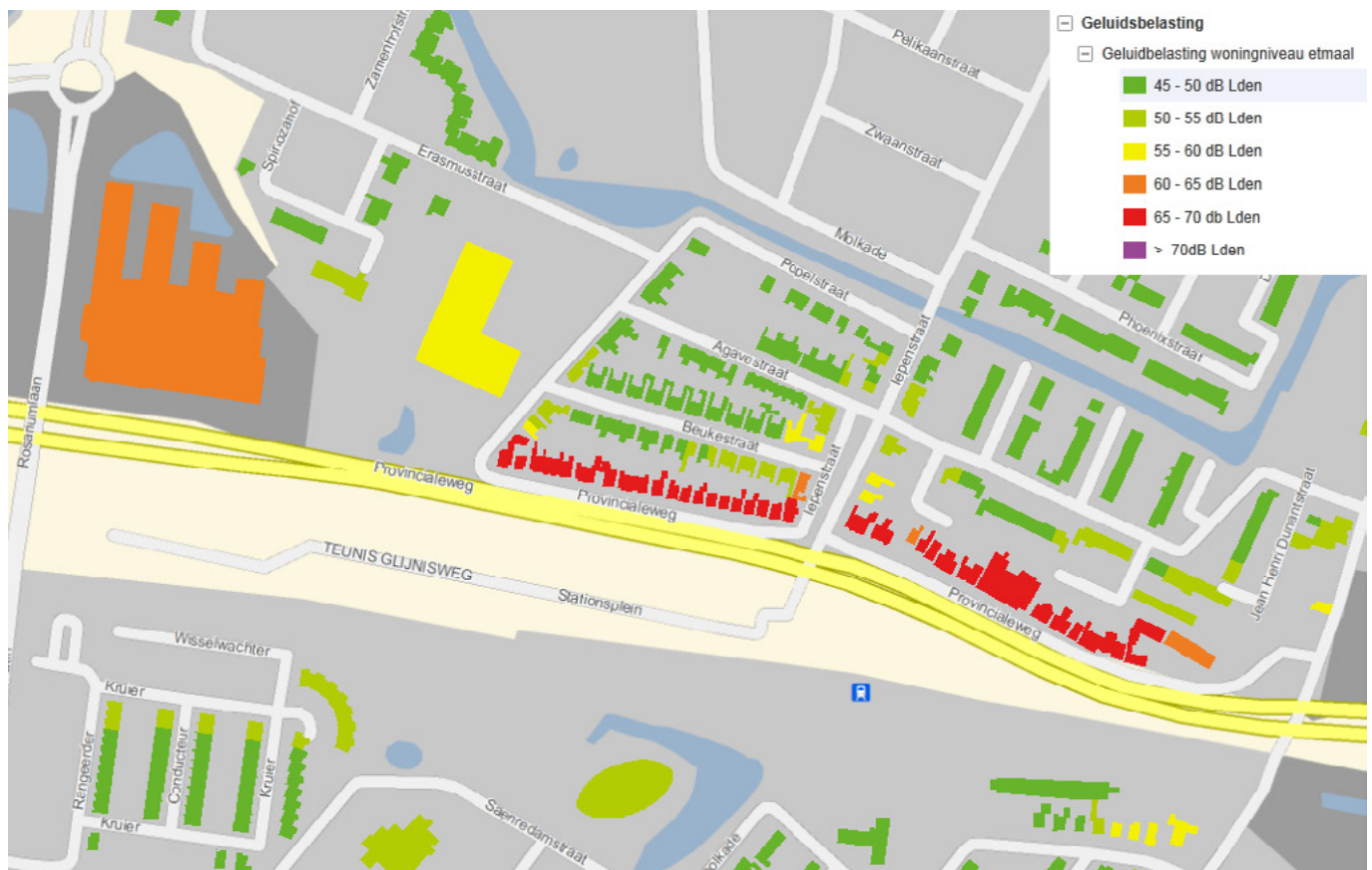
Figuur 2.3 Geluidbelasting op de woningen langs de N203. De rood gearceerde woningen hadden in 2011 een geluidbelasting van meer dan 65 dB 15
