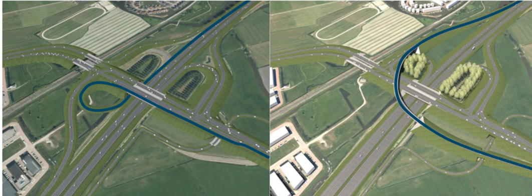
Figuur 4: Zicht vanuit het zuidoosten op de aansluiting A9; Ontwerpboek 3.0 (links) en fly-over variant (rechts) en de route die het verkeer rijdt (blauwe lijn)
