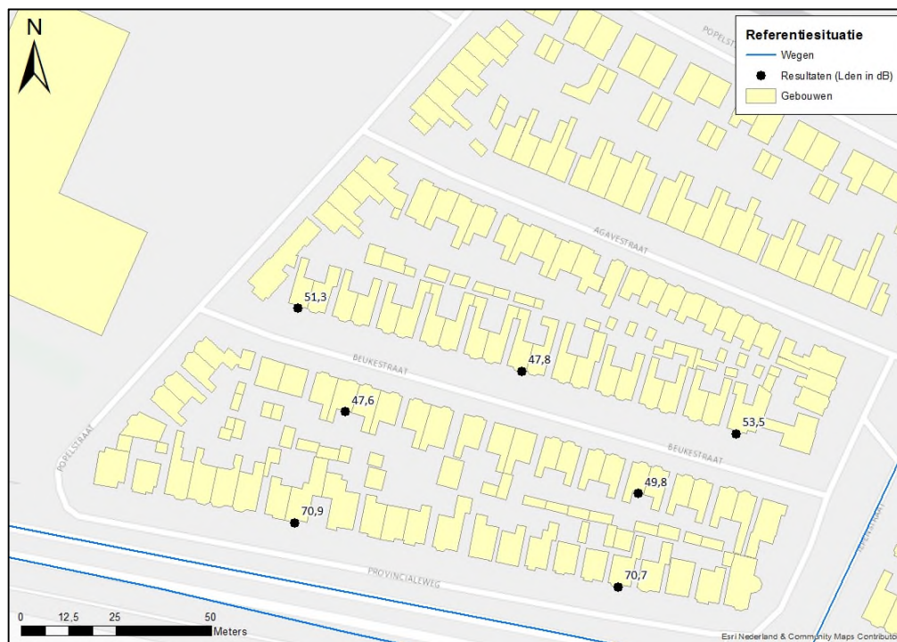
Figuur 5.1: Rekenresultaten geluidbelasting L den op 2 e lijnsbebouwing
