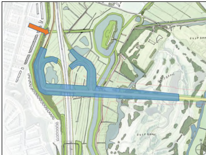
Afbeelding 2.7: Verdiepte ligging aansluiting
